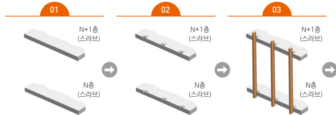
1단계 설치 위치 검토 및 기준점 확인
